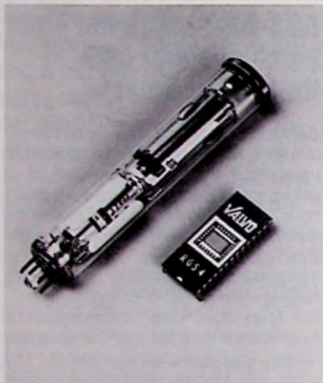
Bild 1: Größenvergleich zwischen 1/4"-Vidikon und RGS-Bildaufnehmer Valvo-Pressbild
